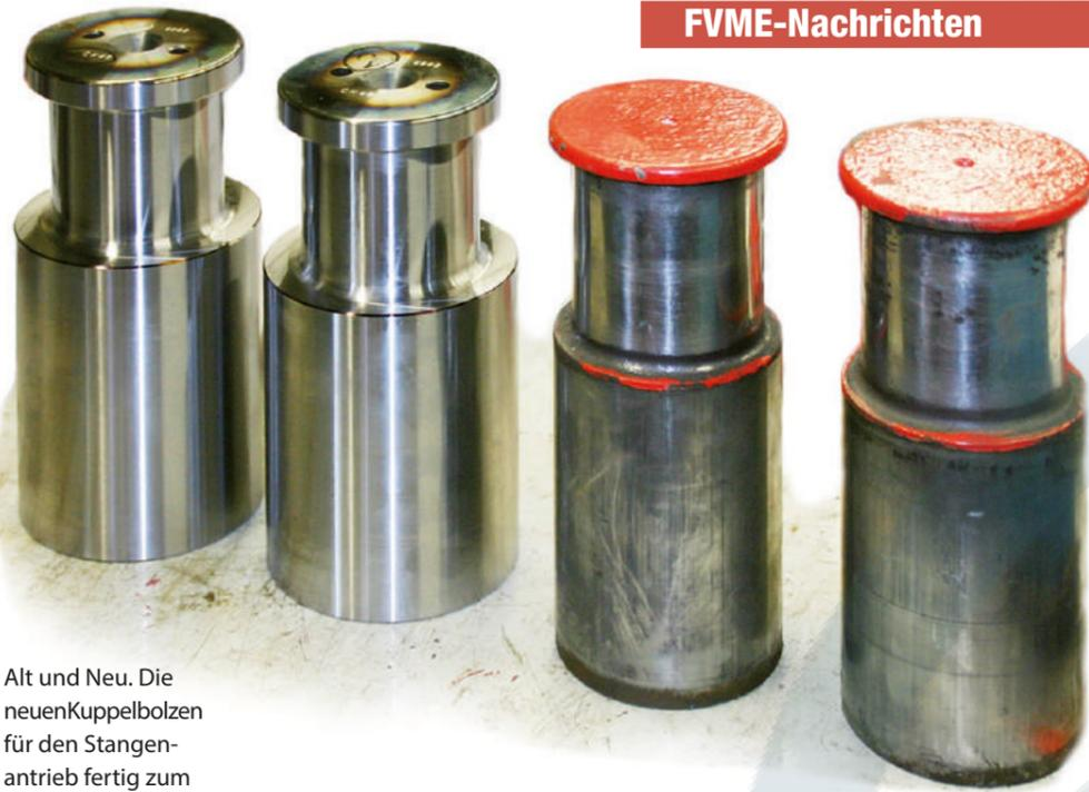
Alt und Neu. Die neuen Kuppelbolzen für den Stangenantrieb fertig zum Einpressen.
