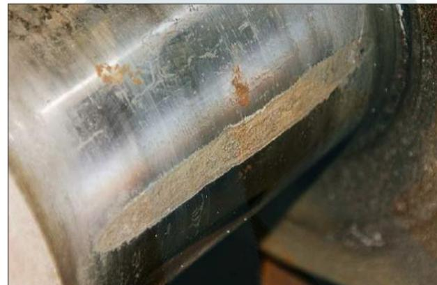
Freien sahen. Da die „ME 4092“ zu dem Zeitpunkt noch „Oberschmierung“ der Radsatzlager hatte und die Schmierkanäle vom über dem Lager liegenden Schmierbehälter seinerzeit nicht verschlossen wurden, hatte das in die Schmierbehälter eingedrungene
