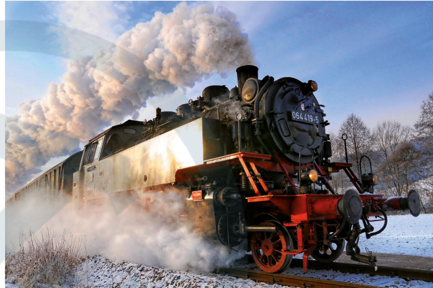
Seit 2008 verkehrt die „Schwäbische Waldbahn“ auf der Strecke Schorn-dorf – Rudersberg – Welzheim mit Lokomotiven des Vereins DBK Historische Bahn e.V. . Dieser Verein besitzt eine Reihe von Lokomotiven aus der Produktion der Maschinenfabrik Esslingen, von denen insbesondere die Dampflok 64 419, mit der Achsfolge 1'C1', aus dem Jahre 1937 häufig auf der Strecke eingesetzt wird ( siehe
