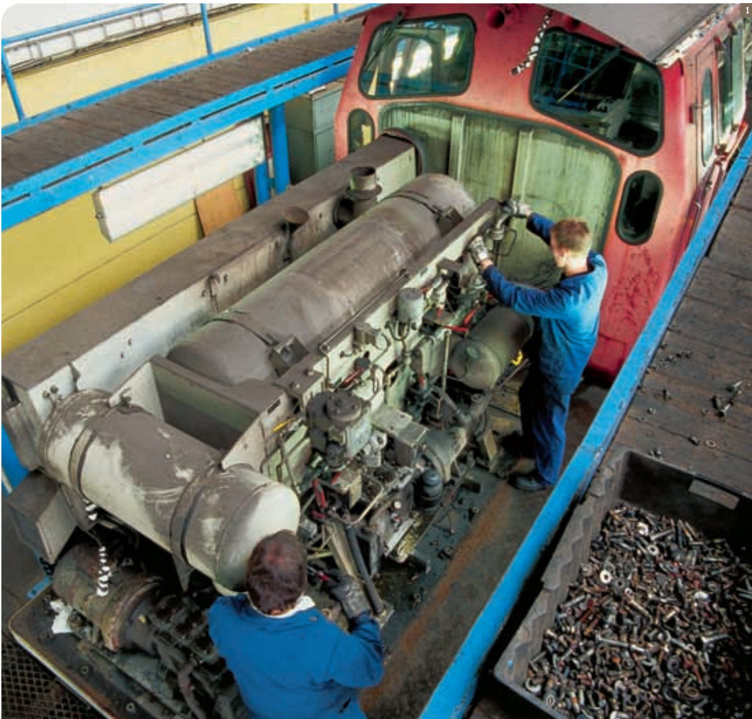
1 Remotorisierung einer V290-Lok: Im Instandsetzungswerk der Deutschen Bahn AG in Cottbus wurden 400 dieser Lokomotiven mit 8V-4000-Motoren remotorisiert. 2 Mit 396er-Motoren können russische DR1A-Züge wirtschaftlich weiterbetrieben werden. 3 Die Alstom-Loks der Thailändischen Staatsbahn werden auf 4000er-Motoren umgerüstet, unter anderem, weil sie 28 Prozent weniger Diesel verbrauchen.
