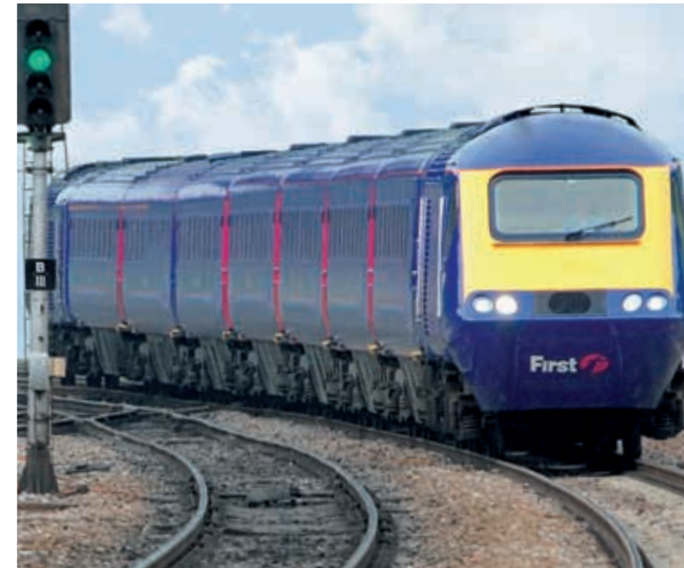
Zu den größten Remotorisierungsprojekten der MTU gehört die Umrüstung der Triebköpfe von englischen Hochgeschwindigkeitszügen mit Motoren des Typs 16V 4000.
