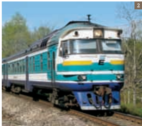
1 Remotorisierung einer V290-Lok: Im Instandsetzungswerk der Deutschen Bahn AG in Cottbus wurden 400 dieser Lokomotiven mit 8V-4000-Motoren remotorisiert. 2 Mit 396er-Motoren können russische DR1A-Züge wirtschaftlich weiterbetrieben werden. 3 Die Alstom-Loks der Thailändischen Staatsbahn werden auf 4000er-Motoren umgerüstet, unter anderem, weil sie 28 Prozent weniger Diesel verbrauchen.
